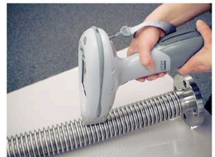
材料检查 (手提式成分分析) Material Inspection (Portable Component Analyzer)
